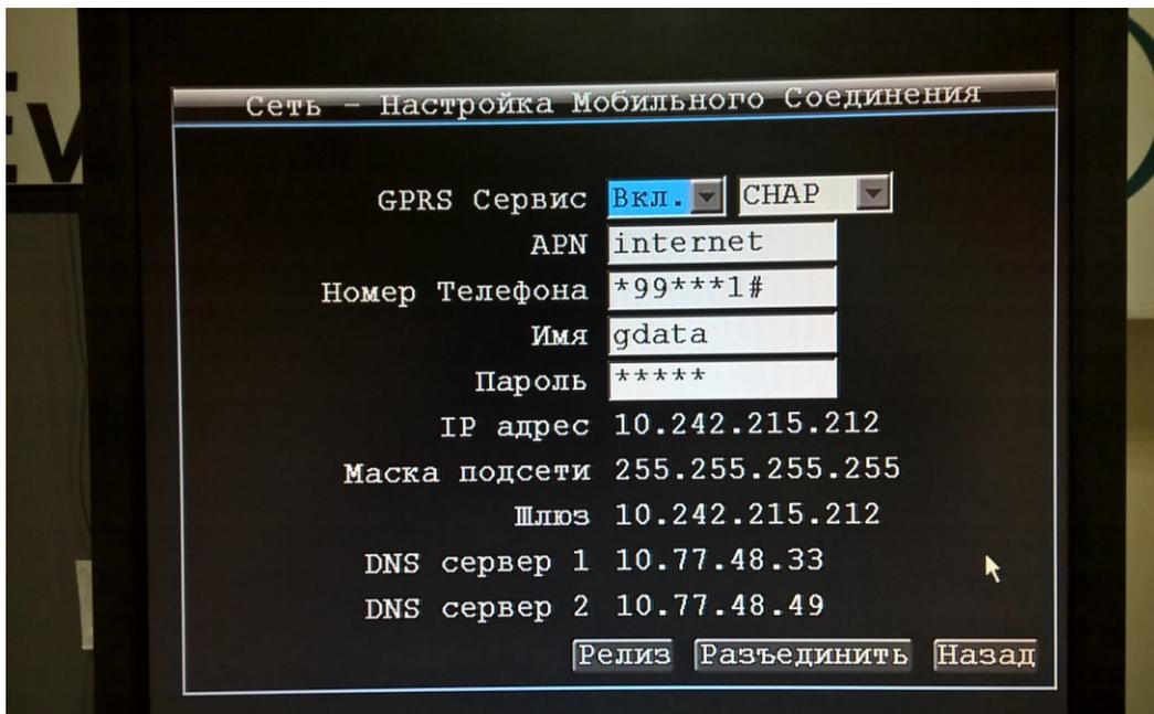
Информация об удачном соединении выводится на графический мониторный интерфейс регистратора. Отсюда же осуществляется контроль за состоянием соединения и настройка отправки данных о тревоге на сервер, а так же прямое подключение к WEB интерфейсу регистратора EMV800. ( OS Windows,IE10)
